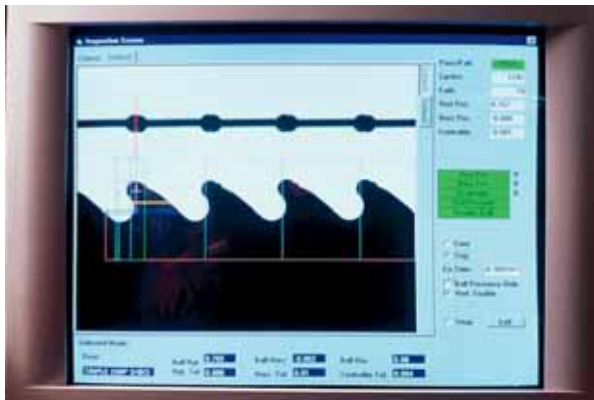
Le Triple Chip est idéal pour les coupes nécessitant un état de surface lisse et un haut niveau de productivité.
